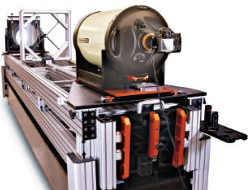
FIGURA 12. În testul final de acceptare, optica EdgeHD trebuie să-și demonstreze capacitatea de a oferi imagini clare de la centrul până la marginea câmpului vizual al unui aparat digital Canon 5D Mark II cu un senzor cu diagonala de 42mm.
