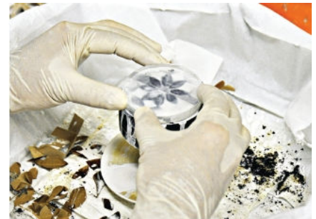
FIGURA 11. Pentru a corecta orice eroare rămasă, oglinda secundară este șlefuită în funcție de întregul sistem optic. Acest proces garantează că fiecare telescop respectă criteriul difracției limitate.
