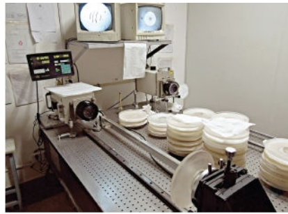
FIGURA 10. Testăm toate oglinzile principale pe un banc optic, prin intermediul interferometriei laser. În această imagine, oglinzi principale polisate așteaptă testarea.
